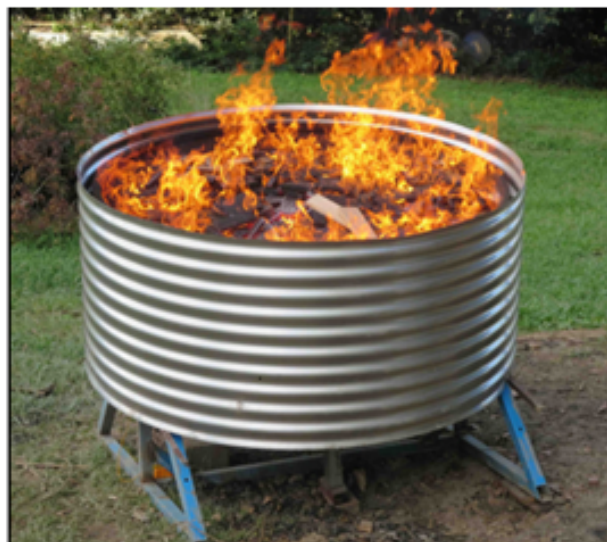
Pyrolyseöfen zur Herstellung von Biochar nach dem Prinzip der Feuerkappe. ( https://wiki.opensourceecology.org ).
